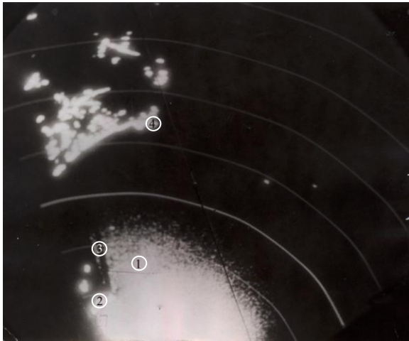
Рис. 8. Затенение отражений от морской поверхности за счет экранировки грядой гор H_B=90 м: 1 – отражения от морской поверхности; 2 – гряда гор; 3 – затененный участок морской поверхности; 4 – отражения от мыса Чауда
